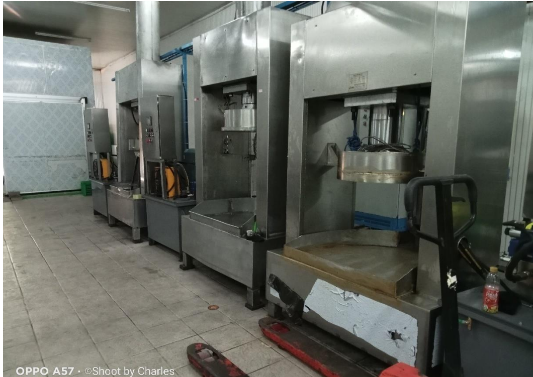
Gambar 4.5. Mesin pressing untuk press santan kelapa.
