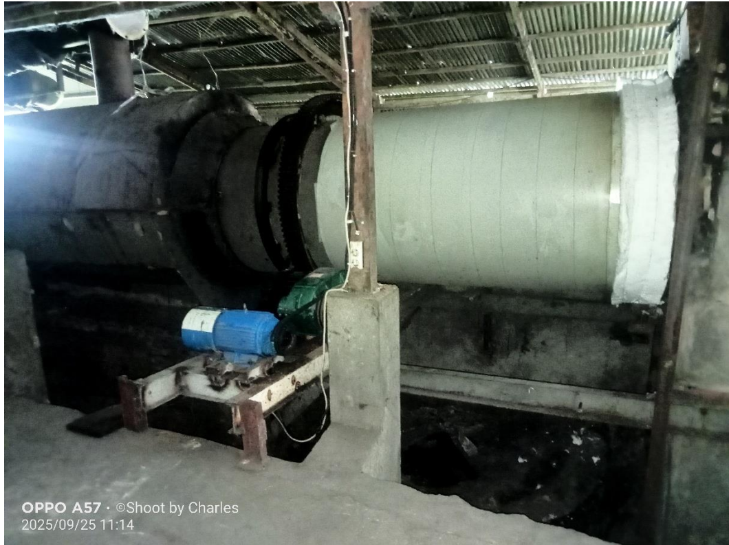
Gambar 4.17. Mesin Pengering Kulit Ari Kelapa.
