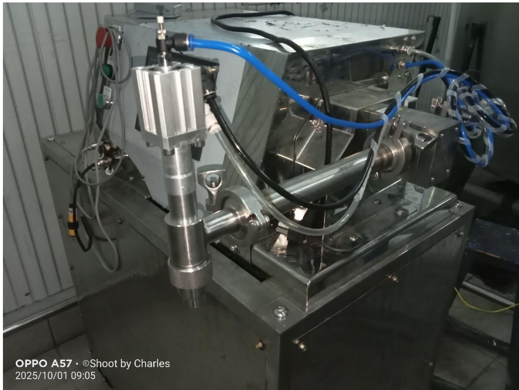
Gambar 4.7. Mesin Packing Santan kelapa menggunakan (Packed Filed) HDPE
