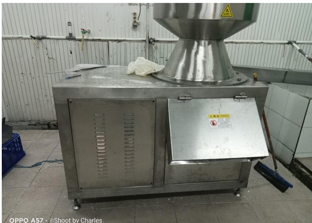
Gambar 4.4. Mesin Grinding daging kelapa
