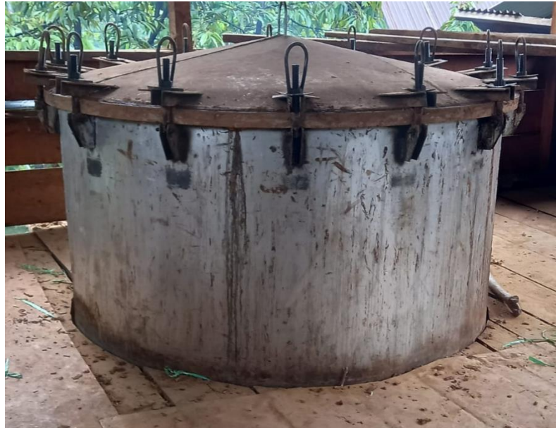
Gambar 2.1 Tangki penyuling di Penyulingan Nilam “JO”
