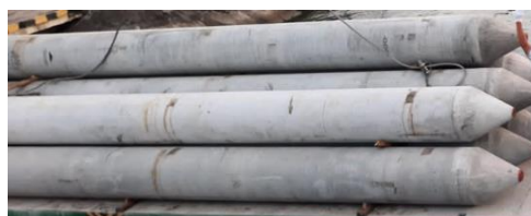
Gambar 4. 7 Tiang pancang beton
