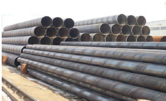
Gambar 3. 5 Tiang pancang baja
