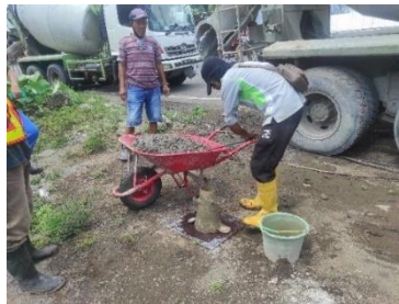
Gambar 4.6 Pengujian Slump test [9]
