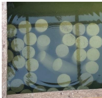
Gambar 4.10 Perendaman Sampel Uji [9]
