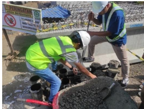
Gambar 4.8 Proses Pemasukan Sampel Uji [9]
