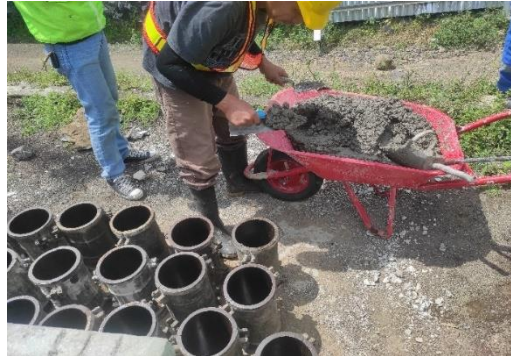
Gambar 4.7 Proses Pencetakan Sampel Uji [9]
