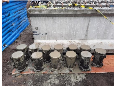
Gambar 4.9 Proses Pengeringan Sampel Uji [9]
